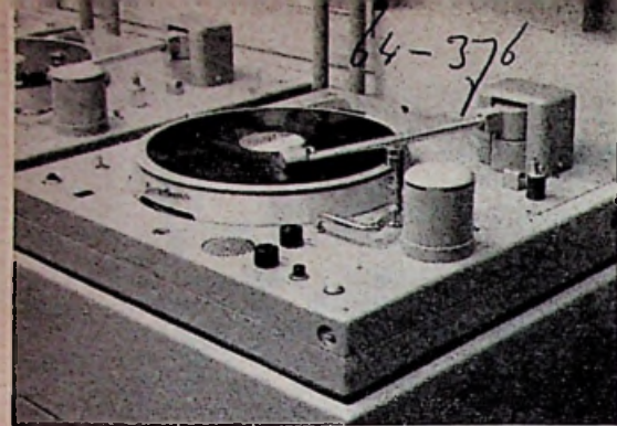
Afb. 3 - EEN DER STUDIO-DRAAITAFELS VAN DE R.T.F. De pickup-arm en het magnetische element met 4 polen, type PCE25B, zijn vervaardigd door de firma Pierre Clement, volgens specificatie van de R.T.F.
